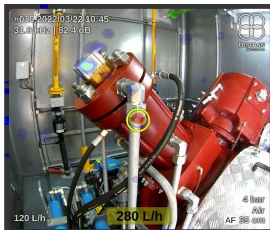
La caméra DISTRAN calcule également le débit de l'échappement de gaz. Cette indication permet de classer les fuites par degré de priorité. Les photos enregistrées sont intégrées au rapport d'inspection.
